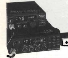
ALAN 18 - 28 - RTX veicolare 40 ch., 26965 - 27405 MHz - MIC/GAIN.
