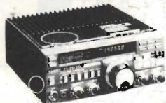
FT757 GXII - Potenza 100W RX-TX 0,1+20 MHz copertura continua
