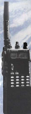
TH 77 RICETRASMETTITORE BIBANDA VHF/UHF
